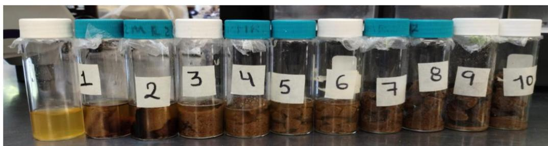
**Figura 15.** Pruebas de retención de orina. De izquierda a derecha: muestra de orina, 1 y 2) 100% poda, 3 y 4) 25/75 malta/poda, 5 y 6) 50/50 malta/poda, 7 y 8) 75/25 malta/poda, 9 y 10) 100% malta
