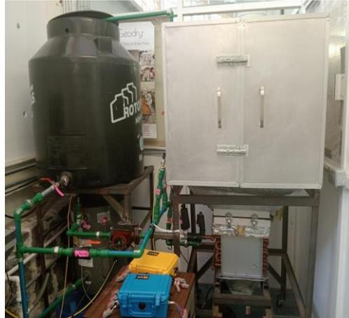
**Figura 8.** Deshidratador geotérmico de alimentos (prototipo de laboratorio)
